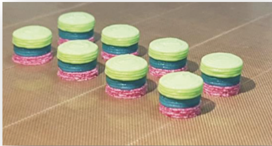
▲ Compresse in tre differenti strati stampate in 3D
